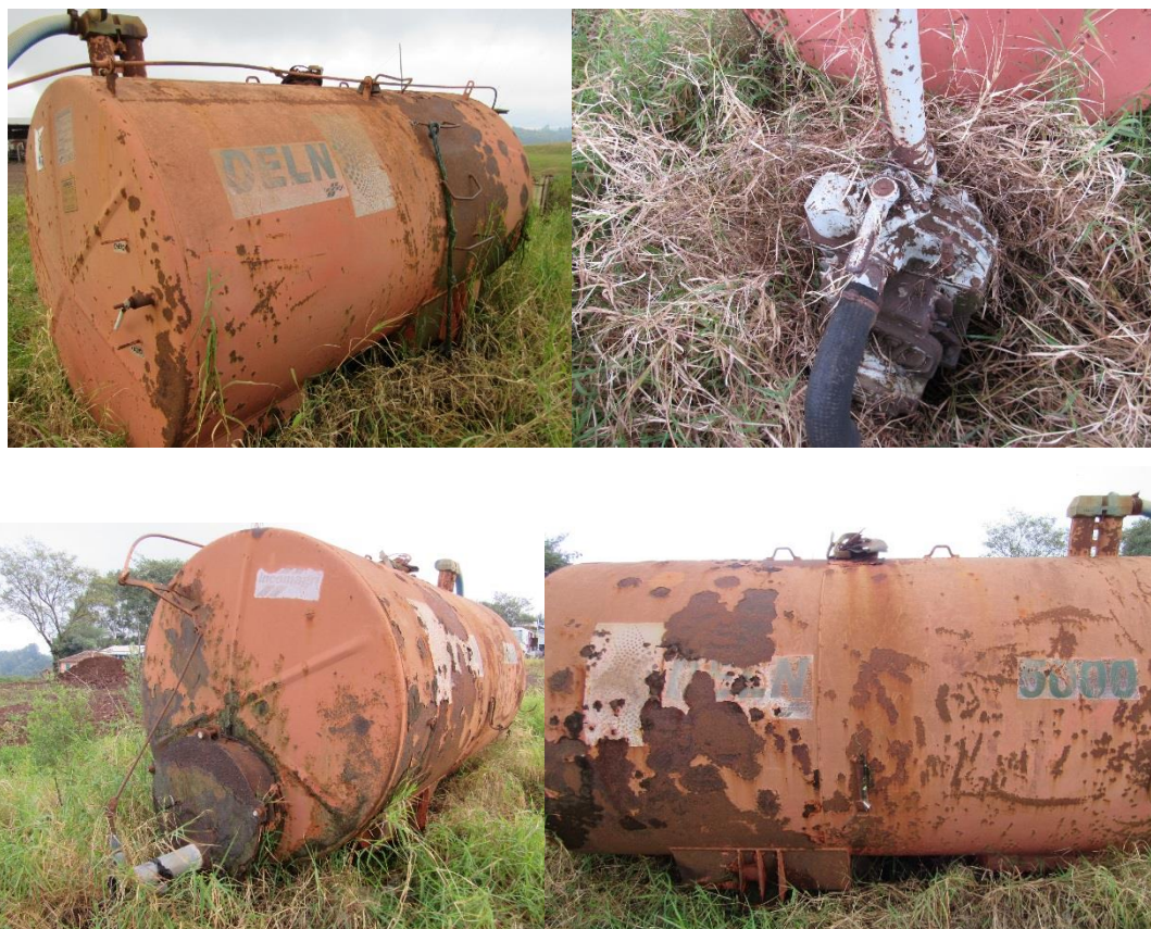
Figura 3 – Parte apresenta processo de oxidação
